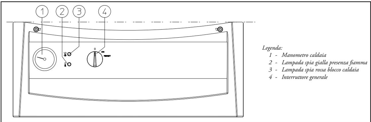
**Accensione della caldaia.** Prima dell'accensione verificare che l'impianto sia pieno d'acqua controllando che la lancetta del manometro (1) indichi un valore compreso fra 1÷1,2 bar, il Comando Amico Remoto sia collegato ed il suo selettore sia posto in posizione Estate o Inverno.
