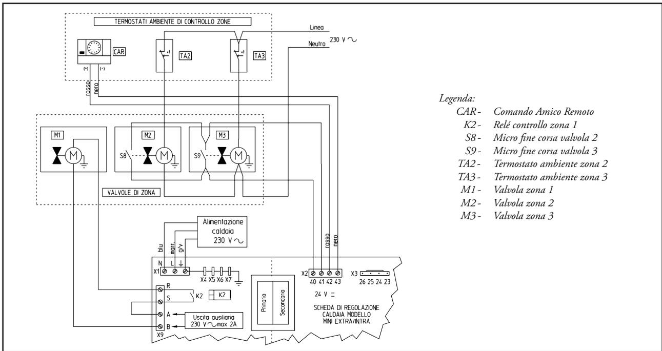
**Attenzione:** qualora si utilizzi come valvola di zona principale quella comandata dal C.A.R. (vedi schema "M1") e questa non è ad apertura rapida (tempo inferiore a 5 secondi), occorre installare in caldaia o sull'impianto un by-pass.
