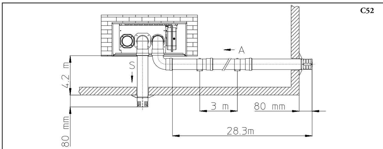
**N.B.:** durante l'installazione dei condotti Ø 80 è necessario installare ogni 3 metri una fascetta rompitratta con tassello.
