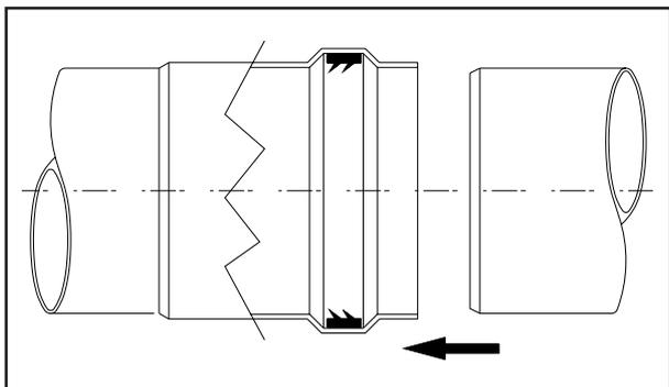
**Installazione diaframma.** Per un corretto funzionamento della caldaia è necessario installare sull'uscita della camera stagna e prima del condotto di aspirazione e scarico un diaframma (vedi figura). La scelta del diaframma appropriato avviene in base al tipo di condotto e alla sua massima estensione: detto calcolo si può effettuare con l'utilizzo delle tabelle:
